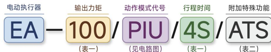
◎EA-100/PIU/4S/ATS 表示：输出力矩为100N·m，开关动作模式输出0~1KΩ信号，带力矩限制装置，行程时间4秒。
