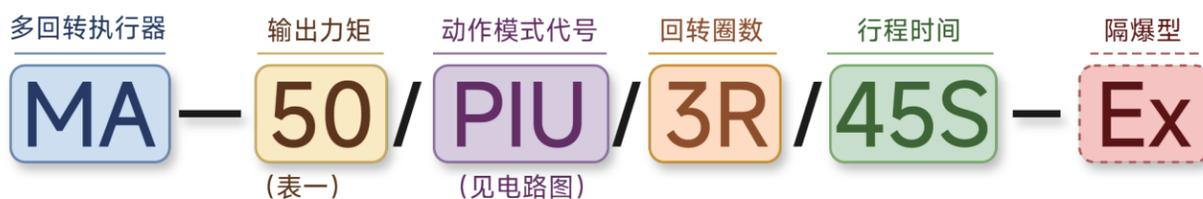
◎ MA-50/PIU/3R/45S 表示：输出力矩为50N·M，开关动作模式输出0~1KΩ信号。
